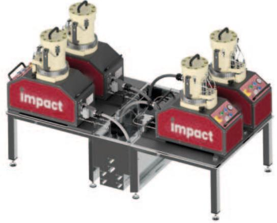
Impact PF-Station EvoCSII送粉器工作站可容纳多达四个Impact EvoCSII 送粉器。根据您的需求，您可以选择两个或四个仓位。两个仓位可以轻松扩展到四个。一个 X 型连接器可以同时使用四个IMPACT EvoCSII送粉器。如果IMPACT EvoCSII送粉器需要维修，可以使用随附的盲板关闭紧急停止电路。因此，根据现有配置，可以在少一个IMPACT EvoCSII 送粉器的情况下继续工作。每个仓位都通过一个永久分配的编号固定在系统中，以避免混淆。
