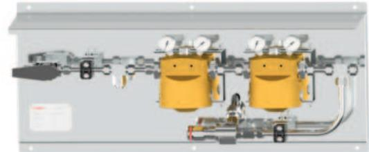
气体供应控制面板N2 是一种减压装置，可将任何氮气供应系统连接到Impact-EC-GM-Unit Evo CSII系统上。该组件设计用于控制高达 200 Bar的最大入口压力。两级压力控制包括两个圆顶减压器，确保稳定的工艺条件。出口压力可在 0-100 Bar之间调节。为了保护后续的 Impact喷涂系统，安装了一个防止过高压力的安全阀和一个防止污染的过滤单元。
