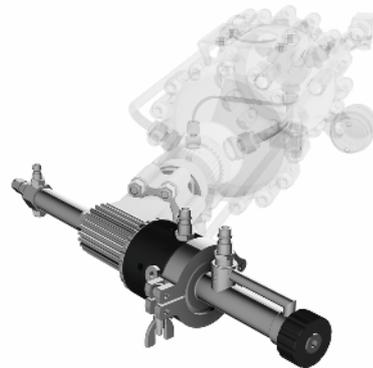
冷却粉末喷射器是中央喷射器套件的附件。它连接到中央喷射器套件，并用压缩空气冷却喷射器管。这对于容易粘附在喷射器上的软材料非常有用。该组件可以根据需要定制长度。
