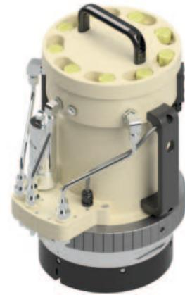
60 Bar粉斗是IMPACT EvoCSII送粉器的附件。借助它，可以进一步提高IMPACT喷涂系统的效率。如果需要重新填充粉末，可以使用额外的粉斗提前完成。这使得等待时间仅限于更换容器，锁定螺栓只需几秒钟，因此，通过避免不必要的停机时间，提高了生产效率。
