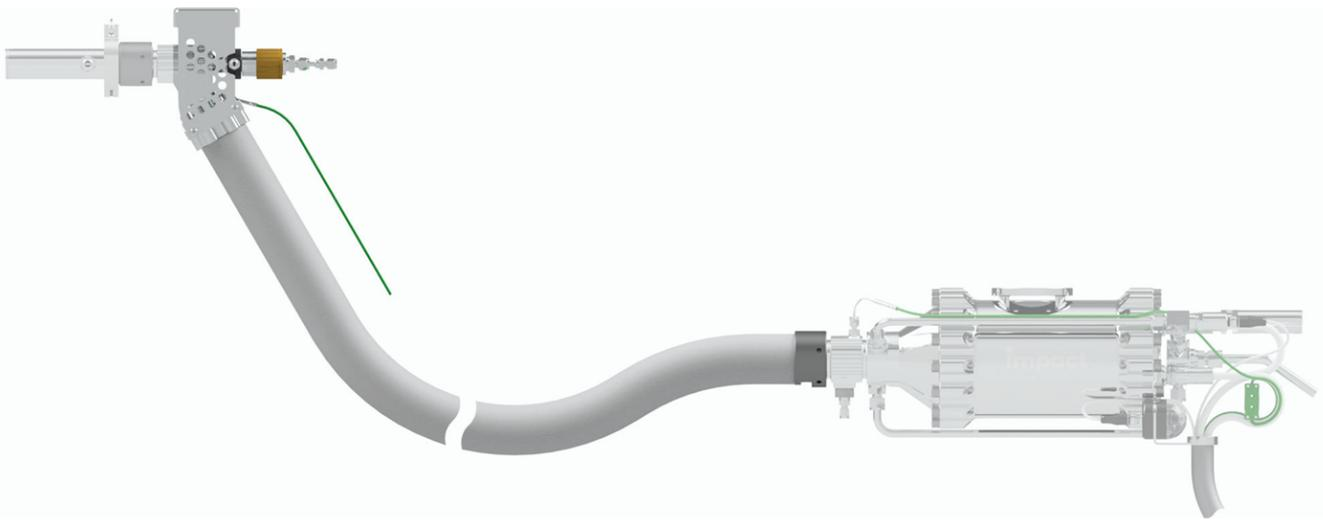
便携式喷枪转换器是IMPACT公司冷喷涂枪的一个附件。它只能与喷枪中央组件一起使用。由于喷枪中央组件与喷枪分离，实现了更灵活的操作。借助紧凑的机械手系统，喷枪转换器能够到达中央组件难以接触的区域。
